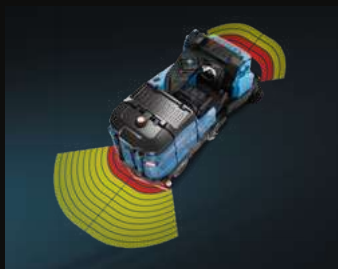
Système anticollision (av – ar)
