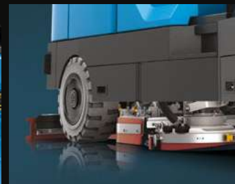
Roues super élastiques avant et arrière
