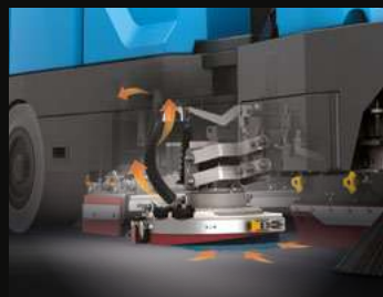
Brosse latérale droite de lavage avec aspiration
