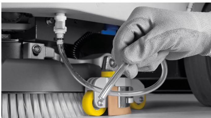
Même le déchargement de l'eau présente dans le réservoir de solution peut être effectué rapidement et facilement grâce au tuyau de déchargement spécial qui peut être accroché à l'avant de l'autolaveuse.
