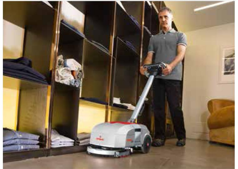
La tête rotative innovante est équipée d'un suceur parabolique qui suit constamment le sens de marche de la machine, offrant ainsi un lavage et un séchage parfaits dans toutes les directions jusqu'aux coins les plus inaccessibles.
