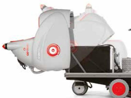
La grande ouverture du capot permet une accessibilité optimale au compartiment des batteries
