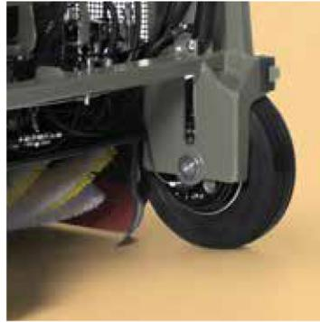
Les roues de grand diamètre non seulement réduisent les contraintes mécaniques mais aussi favorisent le confort. Leur support robuste aide à préserver les caractéristiques de fonctionnement inaltérées dans le temps. Les deux versions sont équipées en série de freins à commande hydraulique
