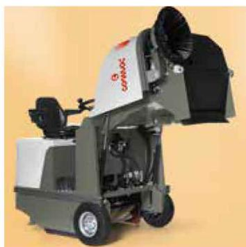
La pression et le réglage de la hauteur de la brosse centrale sont commandés simplement depuis la poignée placée près de la brosse. Le réglage de la hauteur de la brosse en fonction de son usure peut donc être effectué avec une grande facilité. Cette opération permet d'allonger le cycle de vie de la brosse
