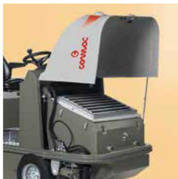
Le simple contrôle de l'huile ou le changement des filtres, par exemple, dans la version motorisée, ont été portés à une facilité extrême. Dans la version B, le boîtier accueillant les dispositifs électriques est situé dans la zone centrale de manière à permettre un contrôle facile et rapide de ces derniers et du niveau du liquide dans les éléments des batteries. Il est possible de prévoir l'installation du bac à batteries pour une capacité allant jusqu'à 480 Ah C5 (version CS90B-CS110)
